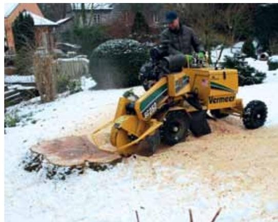
Wenn man einen Baumstock entfernen lassen möchte, weil er z.B. für eine Neubepflanzung im Weg ist, ist diese Maschine die schonendste Variante. Nach dem Baumstockfräsen/Wurzelstockfräsen bleibt nur noch ein Gemisch aus Erde und Holzspänen.
